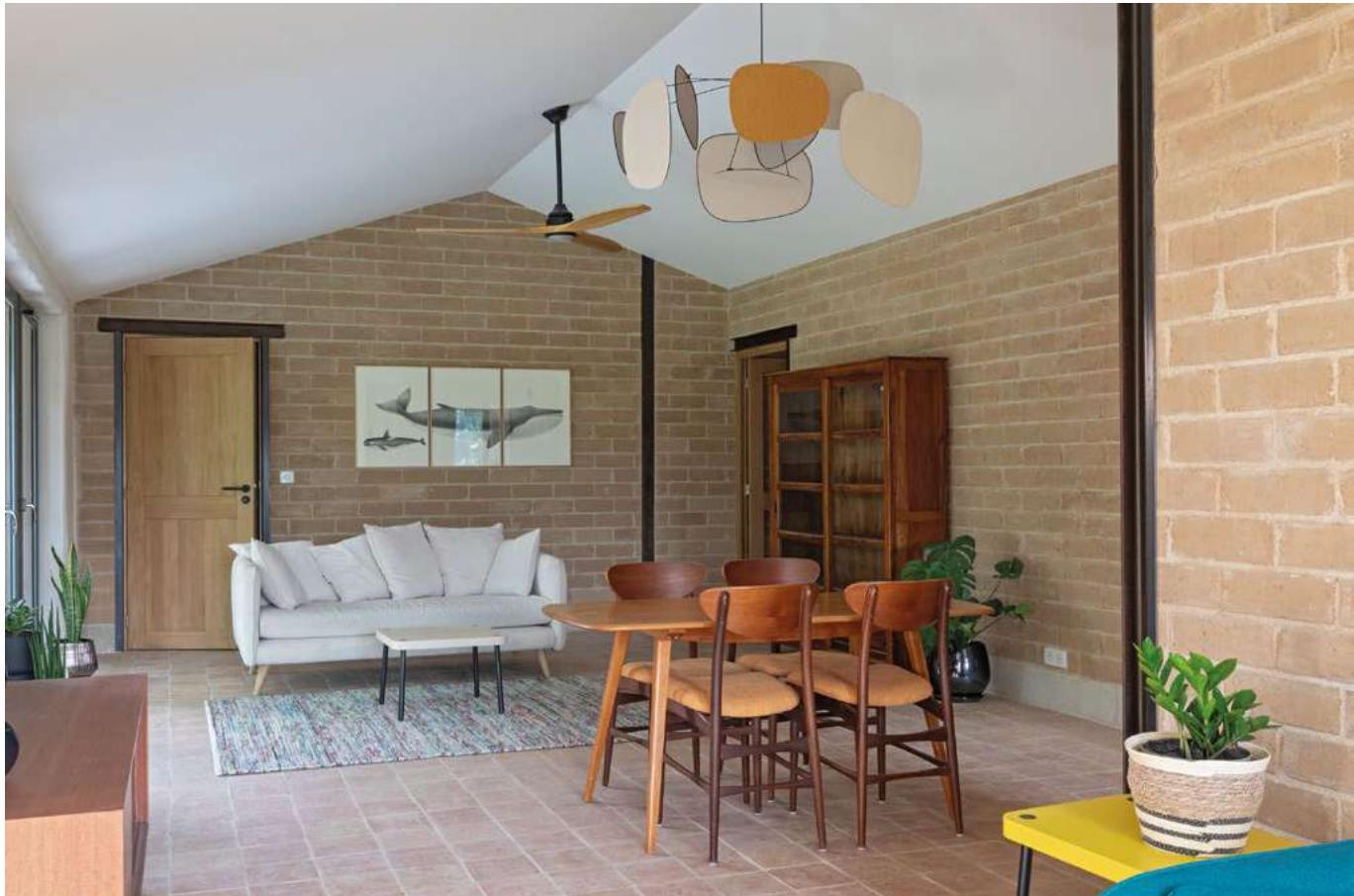
Dans la pièce commune, meubles chinés et achetés sur internet. Côté confort, la forte inertie thermique offerte par les matériaux mis en oeuvre associée à une forte isolation dispense de climatisation. Le brasseur d'air ne fait pas baisser la température mais crée en tournant une légère brise très agréable. D'autres brasseurs d'air ont été installés dans les chambres. Au sol, terres cuites de Raujolles au sol (Millau) posées sur une chape de chaux.
